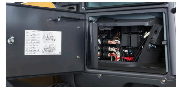
Las puertas laterales con apertura tipo "ala de gaviota" permiten total visibilidad y accesibilidad a los componentes internos. Todos los puntos de inspección diaria están al alcance del operador desde el piso.
