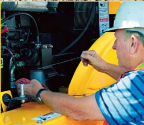
Puede llegar a todos los puntos de verificación diarios desde el suelo y alcanzar fácilmente los componentes principales del motor a través de puertas de servicio rebatibles y con traba.
