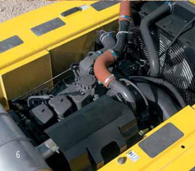
Motor de 6 cilindros dependiente turboalimentado de 6,7 l (409 pulg<sup>3</sup>) que produce 666 N•m (490 pies/lbs) de torque.
